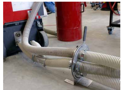
Mobiler Einsatz mit Umschaltfunktion zwischen Einblas- und Saugbetrieb
