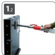
Выдувная насадка с шаровым клапаном
