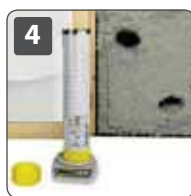
4 Проверка плотности герметизации тестового модуля при помощи набора для проверки плотности NW100
