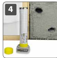
4 Dichteproofung am befüllten Prüfelement mit Dichteproofset NW100
